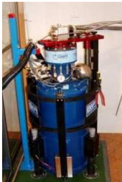
Obr.2: Supravodivý gravimetr GWR OSG-050 ve slapové laboratoři na GO Pecný
