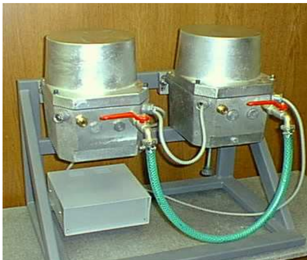
Obr.8: Spřažená čidla hydrostatického systému v provedení pro průmyslové prostředí
