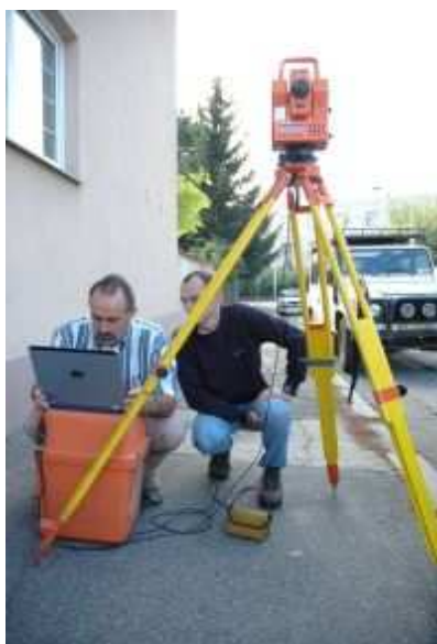
Obr.1: Zpracování dat z měření totální stanice
